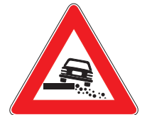
Mod. 21 BANCHINA PERICOLOSA
