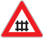
Mod. 8 PASSAGGIO A LIVELLO CON BARRIERE
